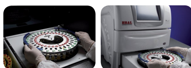
ПЕРЕНОС ВРУЧНУЮ ФЛАКОНОВ посредством специального приспособления из ALFRED 60 в HB&L
